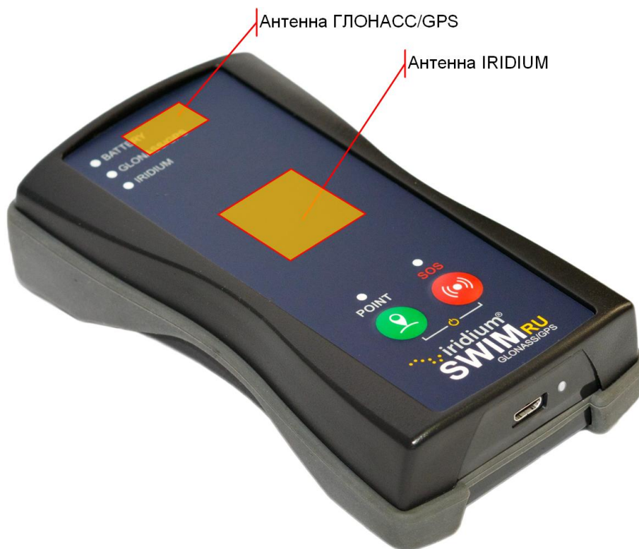
Рисунок 2 - Расположение встроенных антенн трекера
